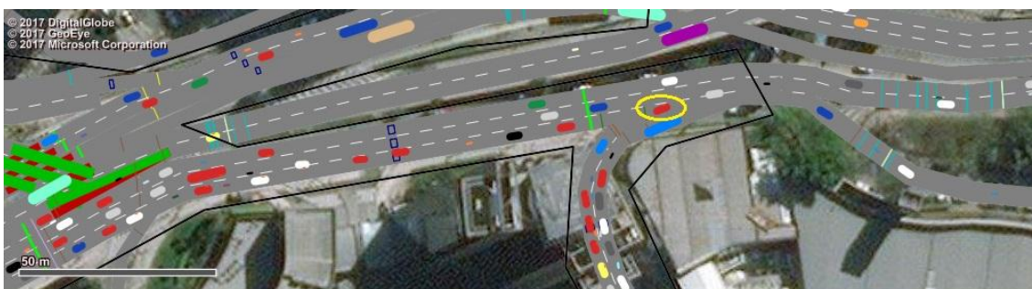
Figura 35 - Sistema de Ramp Metering liberando a passagem dos veículos da R. Bento Frias enquanto as condições de brecha mínima são satisfeitas. Fonte: Elaboração Própria.
