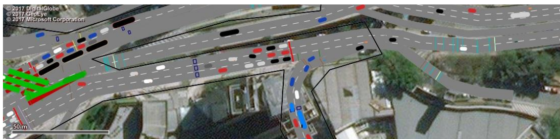
Figura 36 - Sistema de Ramp Metering liberando a passagem dos veículos da R. Bento Frias. Neste caso, não é necessário verificar as condições de brecha mínima, pois o semáforo da Av. Eusébio Matoso encontra-se fechado para veículos. Fonte: Elaboração Própria.
