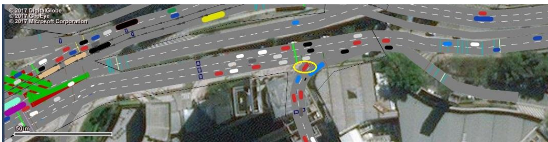
Figura 34 - Sistema de Ramp Metering bloqueado a passagem dos veículos da R. Bento Frias enquanto as condições de brecha mínima não são satisfeitas. Fonte: Elaboração Própria.
